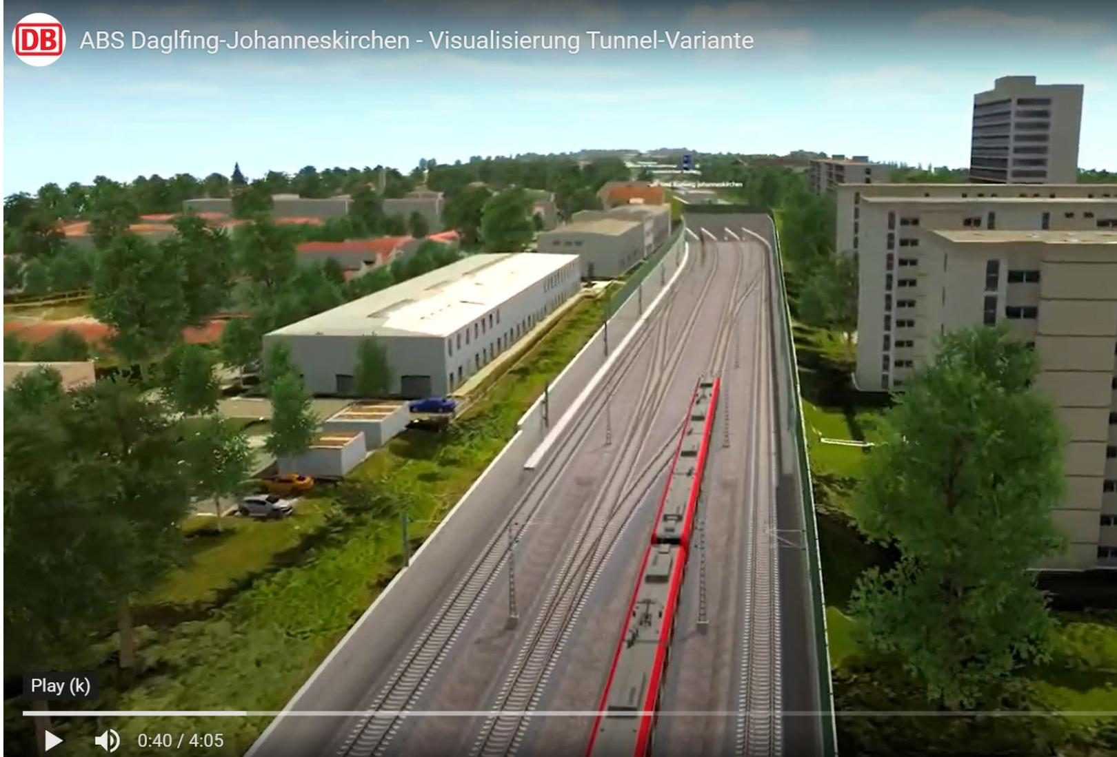
Blick von 300m weiter nördlich Richtung Süden/Tunnelportal. Weichen erzeugen beim Befahren selbst Lärm und verhindern Schachtelung von LSWs, wodurch Lärmschutz weiter sinkt.
