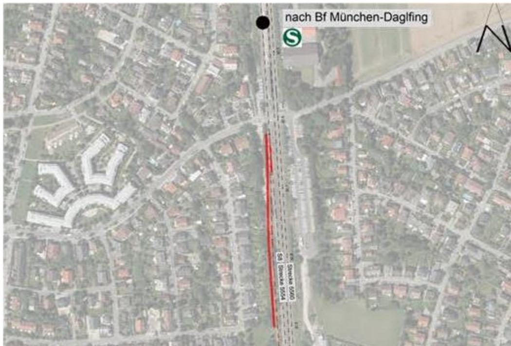
Detail aus DTK-Planung der DB Netze ([Link](#)) mit zusätzlichem Gleis und Lärmschutzwand westlich der Bahntrasse.
